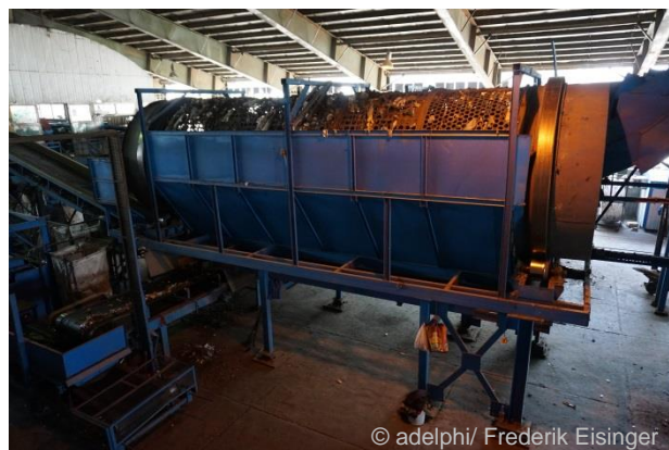
Abbildung 9: Separiertrommel im Arad Khou Komplex
